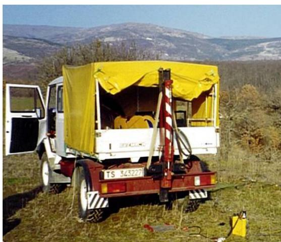
Fig. 2.1.3-2: Sorgente sismica montata su automezzo
