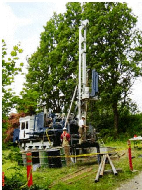
Fig. 3.1-1 Impianto di perforazione Mobil B53
